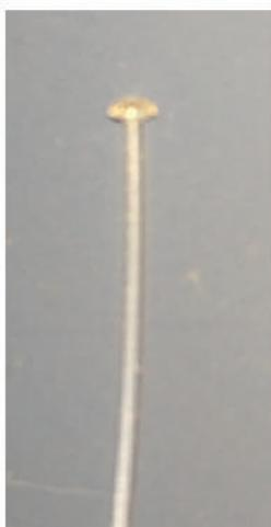
4. Разрезать оптоволокно на 2 одинаковых по длине отрезка. Одну сторону каждого отрезка оптоволокна нагреть при помощи зажигалки до образования «грибка».
