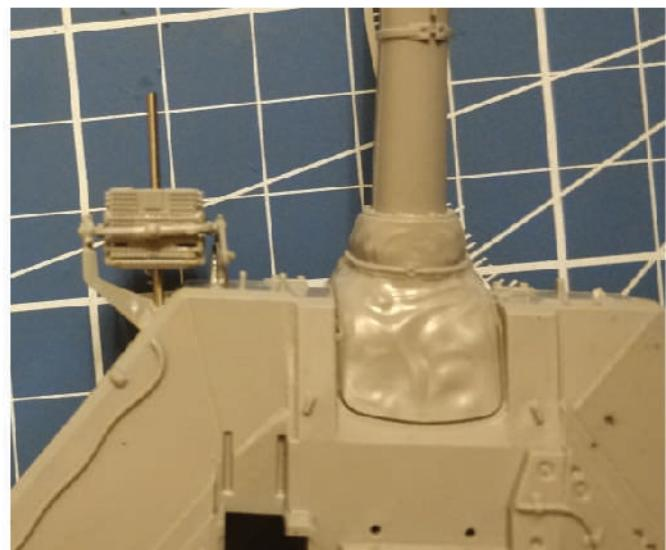
3. Закрепить корпуса прожекторов на башне танка, просверлить башню насеквоздь (через отверстие в прожекторе).
